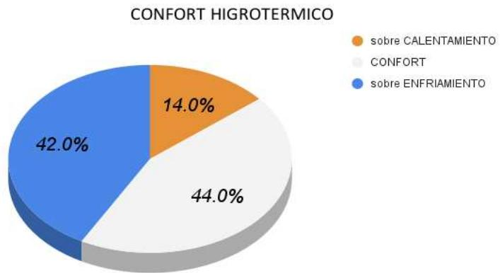
Como leer este gráfico: La cantidad de horas del año (8760) divididas en tres tipos de variables. Porcentaje de horas del año en el que el confort ambiental en el interior de la vivienda permite el NO encendido de dispositivos de climatización. El resto son los porcentajes de encendido de climatización, naranja para el calor, azul para el frío.
